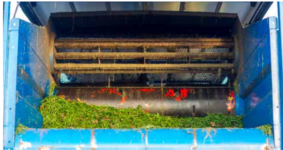
De veevoedersector wil een bepaald eiwit, niet zozeer soja uit Brazilië. Zo verwerkt de mobiele bioraffinage installatie van Grassa regionale gewassen tot een vezelproduct, eiwitconcentraat en een mineralenconcentraat. De verwachting is dat die producten hun weg vinden in de veevoedermarkt en (bio)meststoffen.
